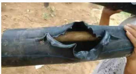
破壞閥門，嚴重的壓強過高造成管道爆管
